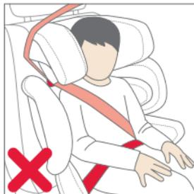
경고! 상체 안전벨트는 비스듬하게 뒤를 향해야 하며, 자동차에서 앞의 상단 안전벨트 포인트 방향을 향하면 안 됩니다. 예를 들어 자동차 좌석을 앞으로 밀거나 다른 좌석에 사용함으로써 이렇게 설정할 수 없는 경우에는 카시트를 해당 자동차에 사용할 수 없습니다. 불확실한 경우에는 카시트 제조사에 문의하십시오. 자동차 내의 수화물이나 다른 물건은 사고 시 부상을 유발할 수 있으므로, 항상 잘 고정해야 합니다. 그렇지 않을 경우 승객과 부딪혀 치명상을 입힐 수도 있습니다.
